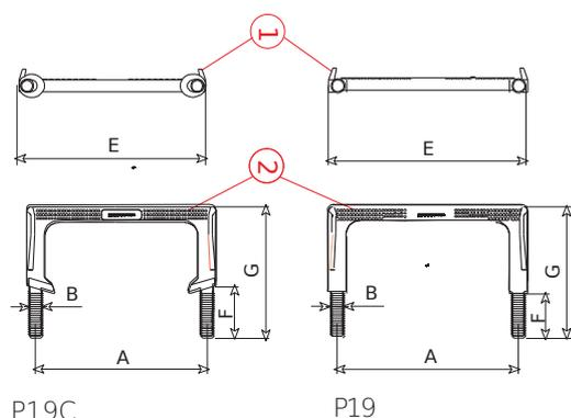
Fabricado en varilla de acero Ø12 **recubierta de polipropileno** para evitar la oxidación.
